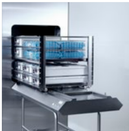
Urządzenie do automatycznego załadunku i rozładunku regałów wsadowych (GL64SR).
